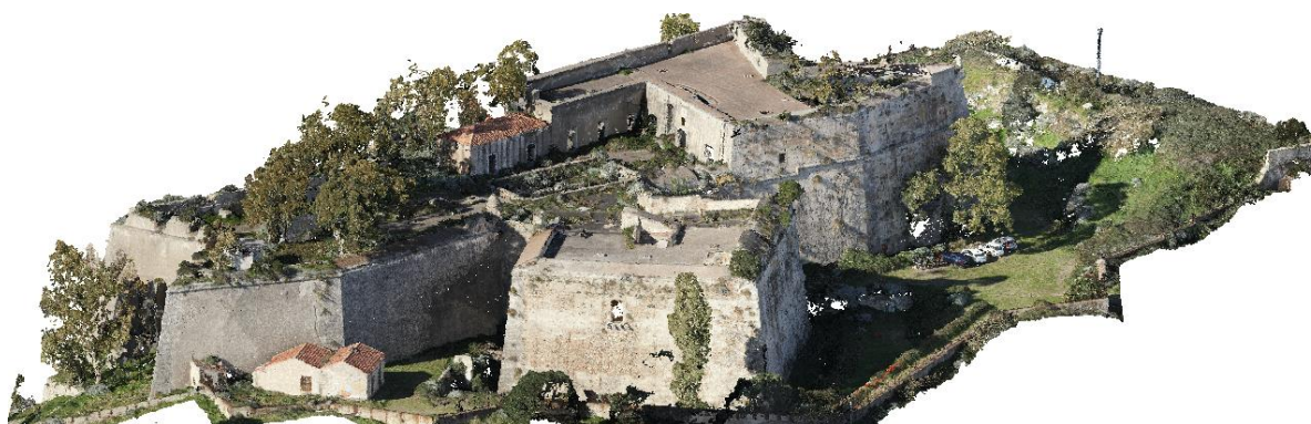
Ricostruzione del modello 3d e rilievo esterno tramite laser scanner – vista aerea lato sud
